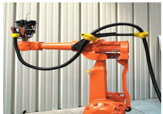
Faisceaux annelés pour application encollage
