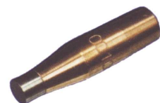
Electrode à pastille rapportée. Emmanchement Cu Cr1 Zr. Partie travaillante Tungstène.
